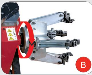
**IT** **MANDRINO AUTO-CENTRANTE:** Mandrino idraulico ad 1 velocità di rotazione nei 2 sensi avente capacità di lavoro da 14" a 26". Lo speciale profilo delle griffe permette diverse soluzioni di bloccaggio al fine di serrare qualsiasi cerchio attualmente commercializzato sui mercati internazionali.
