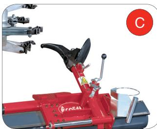
**IT** **BRACCIO PORTA-UTENSILI:** Sollevamento del braccio e rotazione degli utensili ottenuti manualmente attraverso apposito dispositivo di sbloccaggio. Lo speciale profilo semi-sferico del disco di stallonatura permette una più efficace penetrazione tra cerchio e pneumatico.
